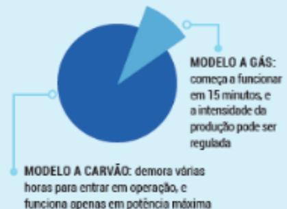
\*Ciclo combinado associa dois modelos de geração de energia. No primeiro, a queima de gás natural aciona uma turbina. No segundo, o ar quente que sai dessa turbina esquenta uma caldeira e gera vapor, que por sua vez aciona um segundo gerador de energia.
